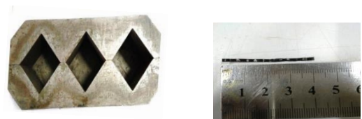
Gambar 1. Cetakan kubus mortar dan serat geotekstil yang sudah dipotong
