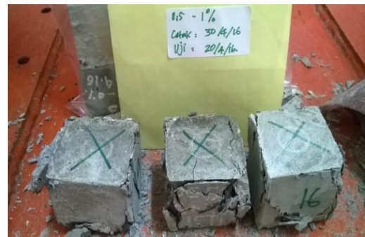
Gambar 15. Benda uji mortar dengan fas 0.5 kadar serat geotekstil 1% pasca uji tekan
