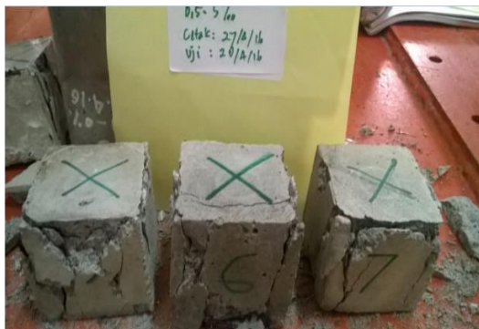
Gambar 12. Benda uji kuat tekan mortar fas 0.5 dengan kadar serat 0.5% pasca pengujian
