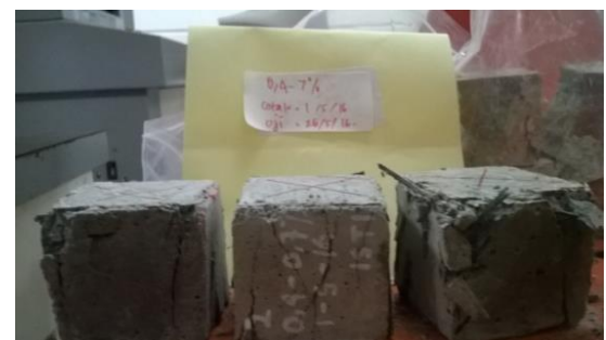
Gambar 9. Benda uji pasca uji tekan pada mortar dengan fas 0.4 dengan serat geotekstil 0.7%
