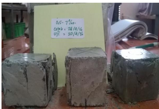
Gambar 13. Benda uji mortar fas 0.5 dengan kadar serat 0.7% pasca pengujian
