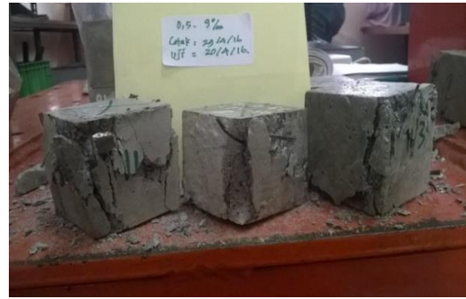
Gambar 14. Benda uji mortar dengan fas 0.5 dan kadar serat 0.9% setelah diuji tekan.
