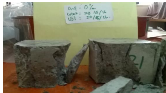
Gambar 8. Benda uji pasca uji tekan pada mortar dengan fas 0.4 tanpa serat geotekstil
