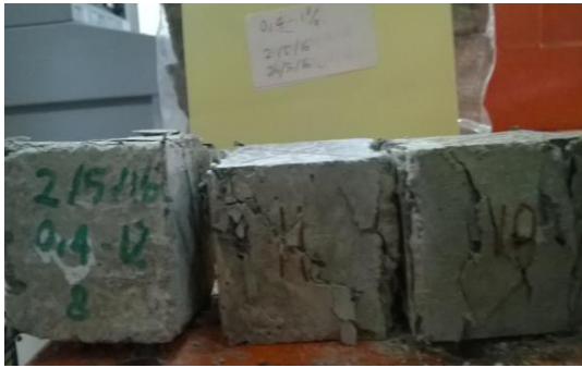
Gambar 11. Benda uji pasca uji tekan pada mortar dengan fas 0.4 dengan serat geotekstil 1%
