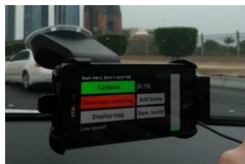
Gambar 1. Posisi device roadroid untuk survei
