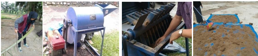
Gambar 4. (a) pengambilan pelepah sawit, (b) alat penghancur pelepah sawit untuk mendapatkan serat pelepah sawit, (c) Pisau penghancur pelepah sawit, (d) serat pelepah sawit sedang dijemur.
