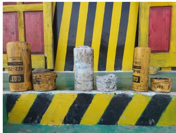
Gambar 2. Perbandingan ukuran filter oli bekas sebelum dipress dan setelah dipress
