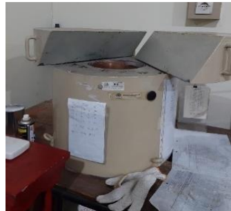
Gambar 1. Spektrometer Gamma detector HGPe seri GEM F5930-XLB C
