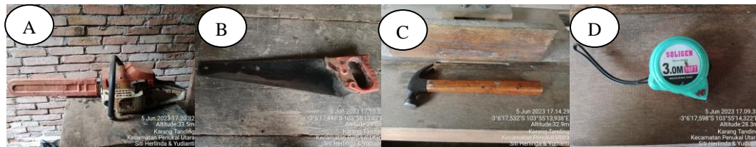
Gambar 3. Alat membuat kotak budidaya : Mesin pemotong kayu (A), gergaji (B), palu (C), meteran (D)
