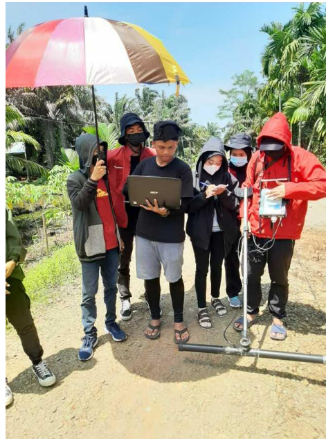
Gambar 4. Akusisi pengambilan data GPR
