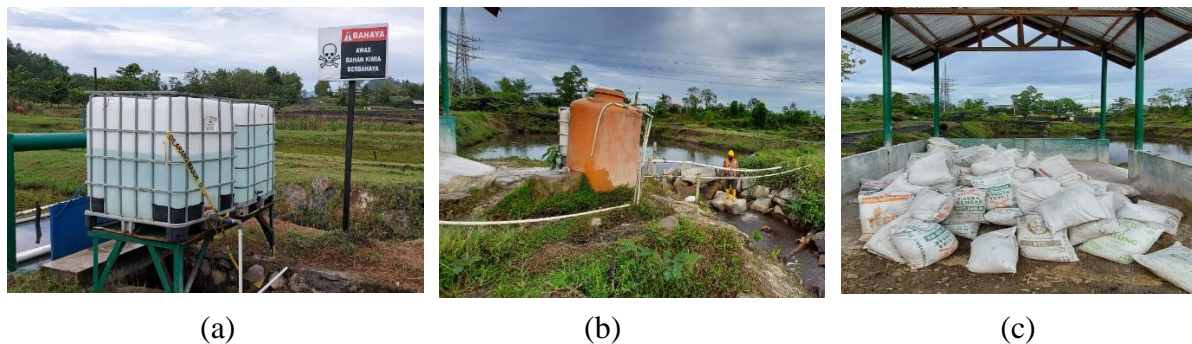
Gambar 1. Pencampuran bahan kimia untuk pengendalian kualitas air asam tambang (a) larutan NaOH (b) bak kuriflok (c) kapur tohor
