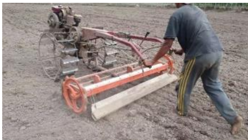
Gambar 6. Alat tanam benih langsung (Atabela) tipe Amator Sumber: http://new.litbang.pertanian.go.id/info-aktual/3006/
