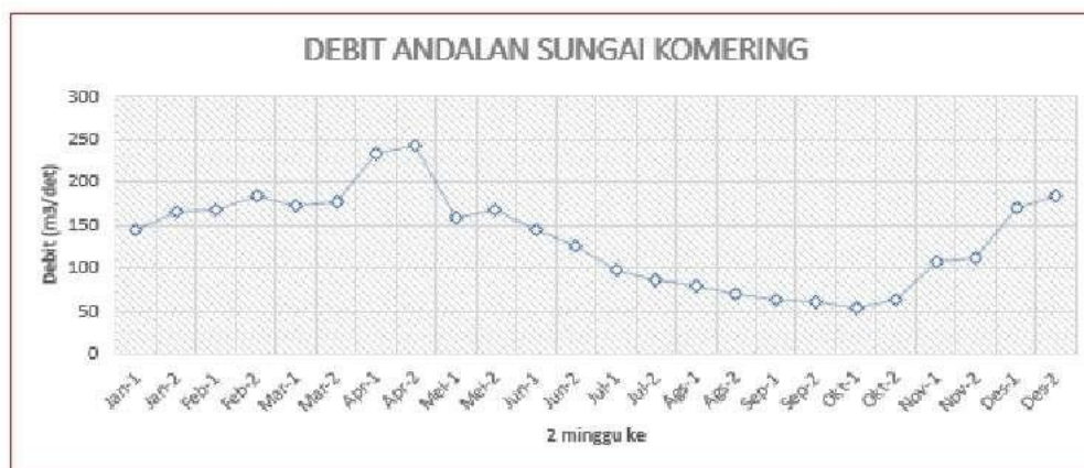
Gambar 3. Debit andalan sungai Komerling selama satu tahun dihitung per dua mingguan Berdasarkan hasil pengukuran di lapangan diperoleh hasil pengamatan dan analisis
