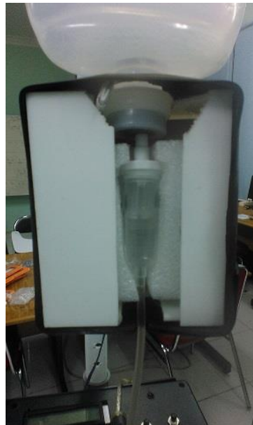
Gambar 6.1 Posisi sensor terhadap infus
