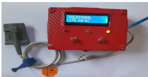
Gambar 1. Prototype Alat Ukur Kadar Kolesterol Darah oleh Maisoha 18
